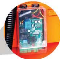
แผงวงจรควบคุม เก็บอยู่ในกล่องพลาสติก เพิ่มความทนทาน กันละอองน้ำ กันฝุ่น
